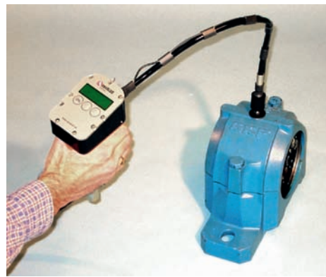
Med ett datoriserat fettmätningssystem kan många mänskliga misstag i smörjningen undvikas och mycket pengar sparas.
